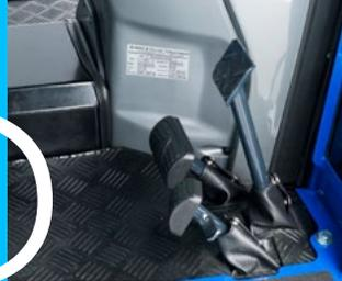
Automatische Steuerung der Motordrehzahl durch Fahrpedal (bei AHL-Version)
