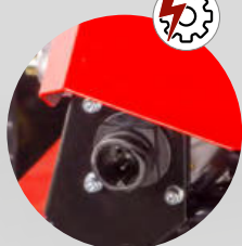
Anbaugeräte-Steckdose (optional) schaltbar
