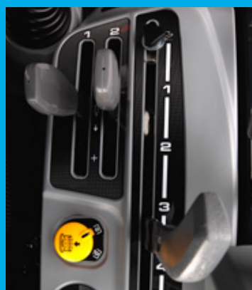
10 Heckhydrauliksteuerung Für vier serienmäßige Hydraulikan Anschlüsse hinten und zwei doppelwirkende Steuergeräte inkl. Schwimmstellung (serienmäßig)
