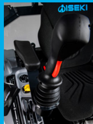
11 Verriegelung Kreuzsteuerhebel In der Profiversion erfolgt die Bedienung über den Freigabetaster am Joystick.
