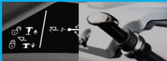
11 Verriegelung Kreuzsteuerhebel In der Profiversion erfolgt die Bedienung über den Freigabetaster am Joystick.
