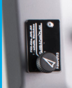
11 Verriegelung Kreuzsteuerhebel In der Profiversion erfolgt die Bedienung über den Freigabetaster am Joystick.
