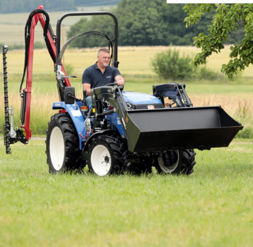
Entsprechend der europ. Sicherheitsnorm für Frontlader (EN 12525) Auslieferung ab Werk mit 4 Pfosten Schutzkäfig (OPG). Eine Nachrüstoption für Altmaschinen ist ebenso verfügbar.
